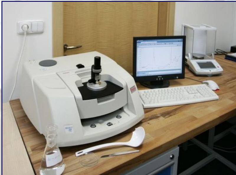
Identifikace typu plastu FTIR spektrometrem
